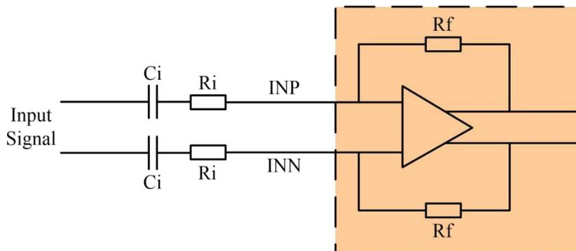
增益确定，也就是输入阻抗确定了之后，输入隔直电容  $C_i$  的选取尤为重要。一方面，电容值直接影响放大器的低频特性；另一方面，开关机 POP 声的抑制性能受电容的影响，如果耦合电容大，则反馈网络的延迟大，pop 声容易出现，相反较小的耦合电容可以减少该噪声。因此，输入电容  $C_i$  的选取要兼顾这两个方面。比如，增益为 20dB，总输入阻抗为 30k，-3dB 转折点  $f_c$  取 53Hz，由上计算公式得  $C_i=0.1\mu F$ 。
