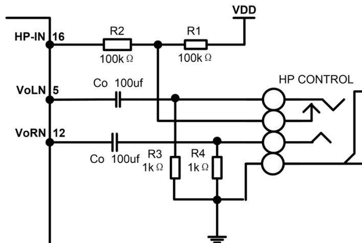
当没有耳机插头接入插孔时, R1-R3 分压电阻使提供到 HP-IN 管脚 (16 脚) 的电压近似为 50mV(低电平), 使 NS4250 工作于桥式输出模式。当耳机插头插入耳机插孔使得耳机插孔与 R3 分离, HP-IN 管脚上拉到高电平。NS4250 工作于单端输出模式 (耳机应用)。
