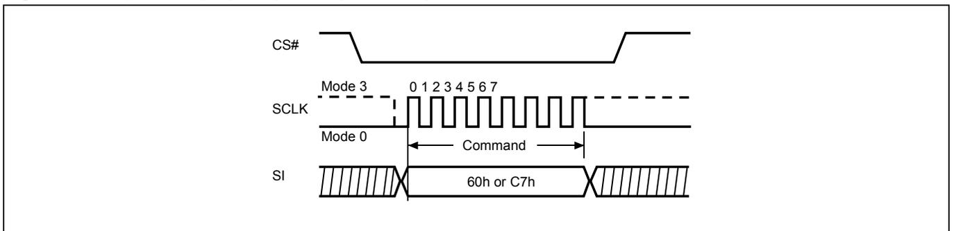
**Figure 50. Chip Erase (CE) Sequence (QPI Mode)**
