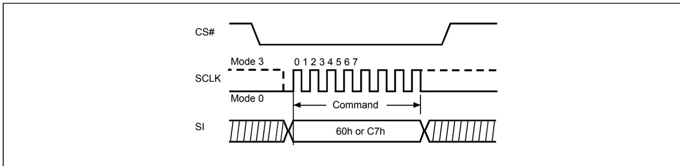
**Figure 85. Chip Erase (CE) Sequence (QPI Mode)**
