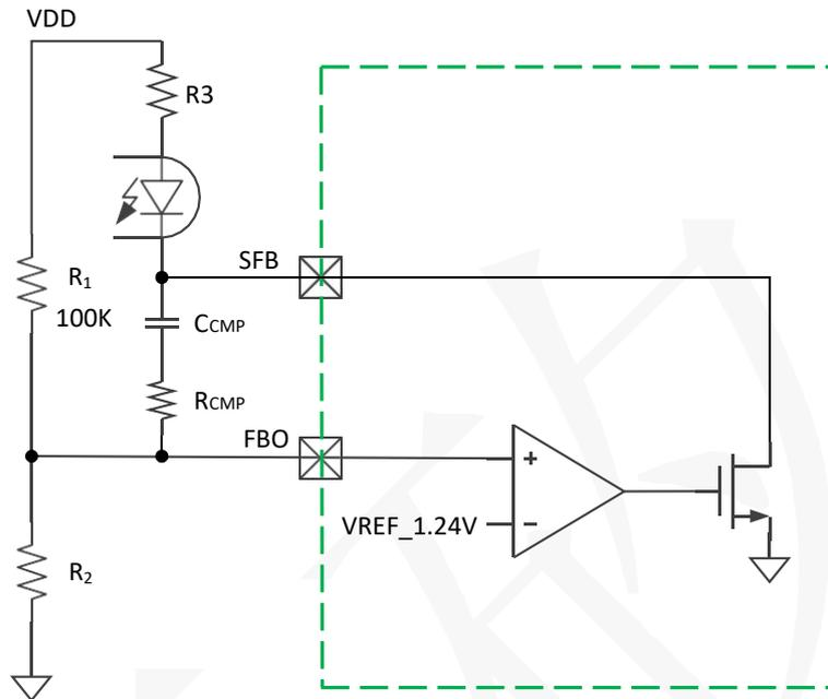
恒压环路（CV）需要在外部进行补偿，补偿电阻  $R_{CMP}$  和补偿电容  $C_{CMP}$  由具体应用决定。FBO 内部的基准电压为 1.24V。VPWR 上的反馈电阻网络的分压电阻  $R_1$  必须接 100k $\Omega$ 。
