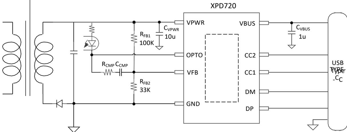
图中所示元器件参数供参考，可以根据实际应用进行调整。参考 8.3 节内容设置反馈网络分压电阻  $R_{FB1}$  和  $R_{FB2}$  的值，以及补偿网络  $R_{CMP}$  和  $C_{CMP}$  的值。
