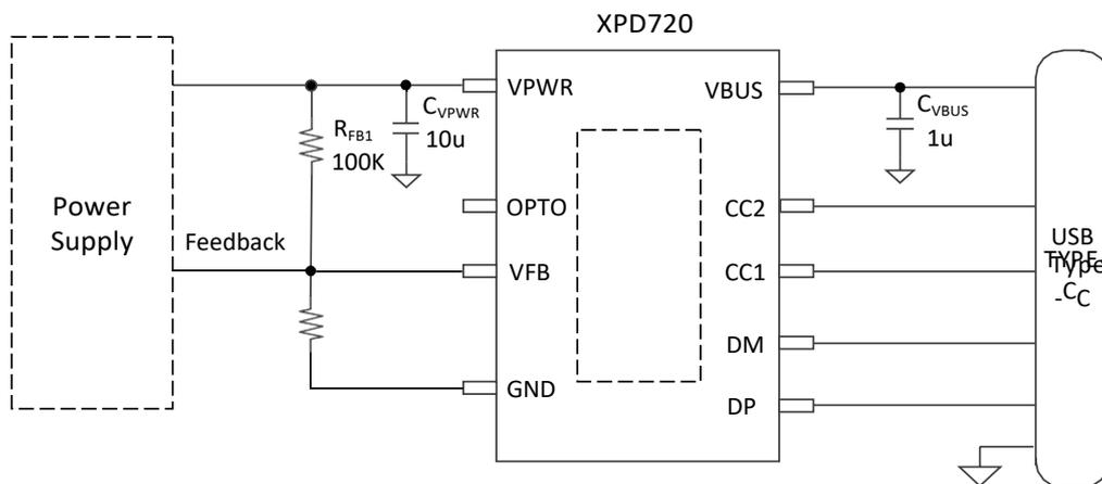
图中所示元器件参数供参考，可以根据实际应用进行调整。VPWR 上的反馈电阻网络的分压电阻  $R_{FB1}$  必须接 100 kΩ。
