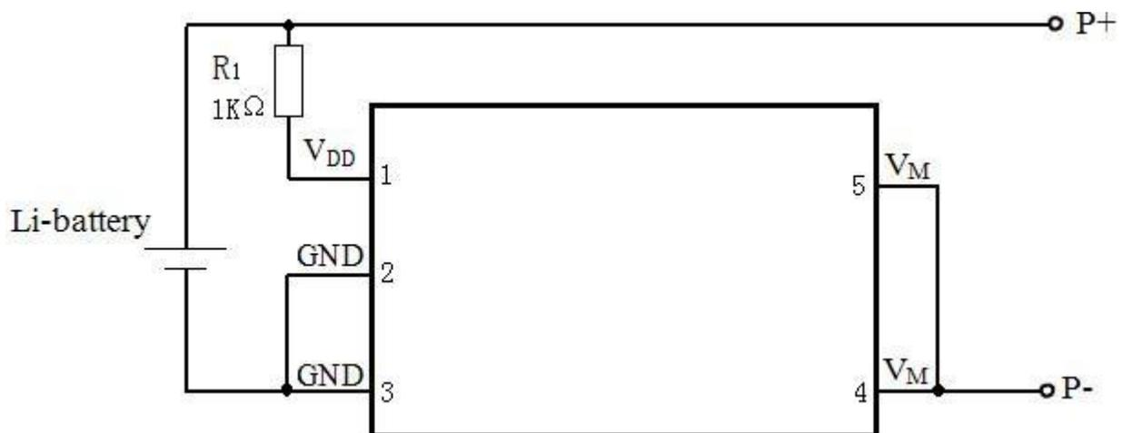
注意：1、注意输入输出电压和负载电流情况，保证芯片功耗不超过封装所承受的最大功耗。
